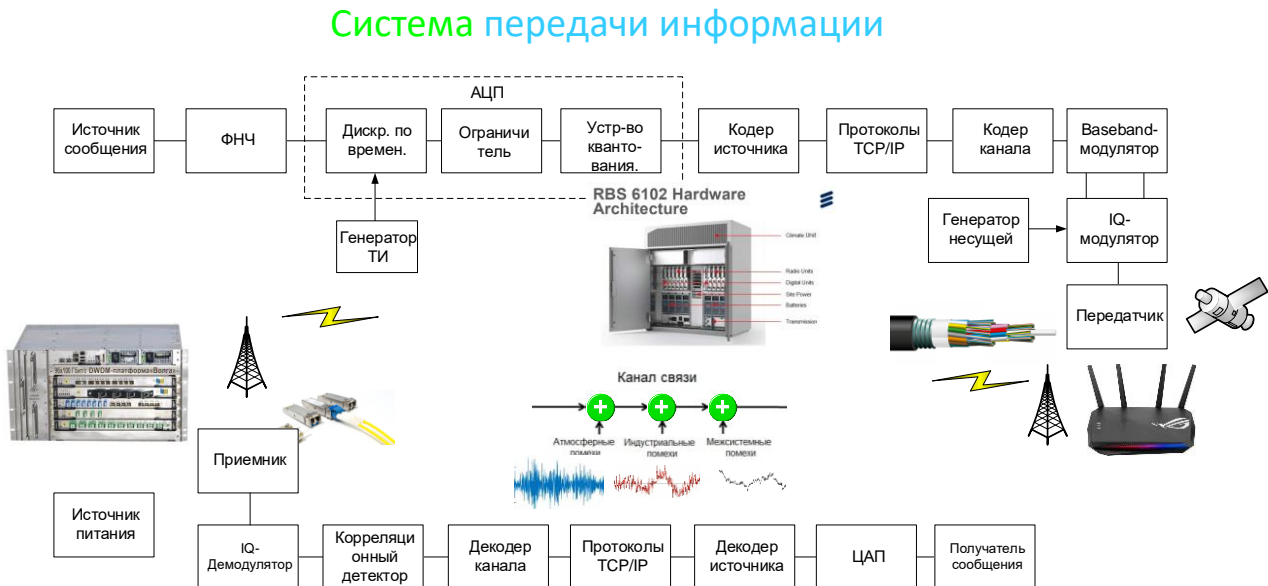
Рисунок 0. Общая структурная схема системы передачи информации
