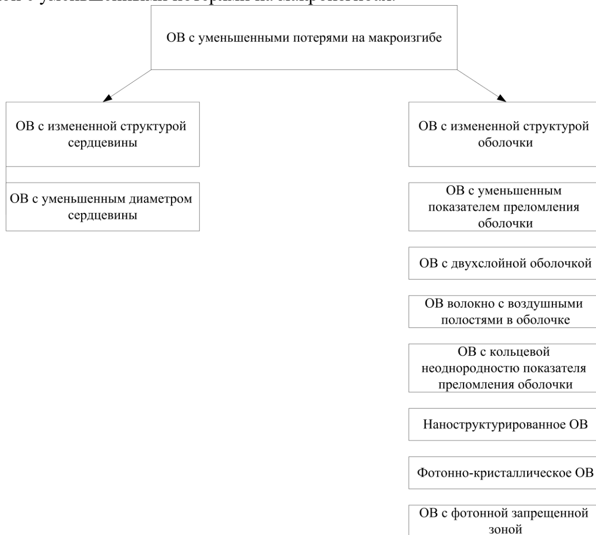
Рисунок 13 – Классификация оптических волокон с уменьшенными потерями на макроизгибе по типу реализации
